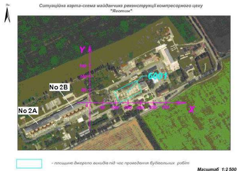
Рисунок 1.7 - КС Яготин: КЦ №2 (2А та 2Б) та площадка демонтованого КЦ №1, що планується для встановлення нових ГПА звіт з ОВД «Яготин» [73].
