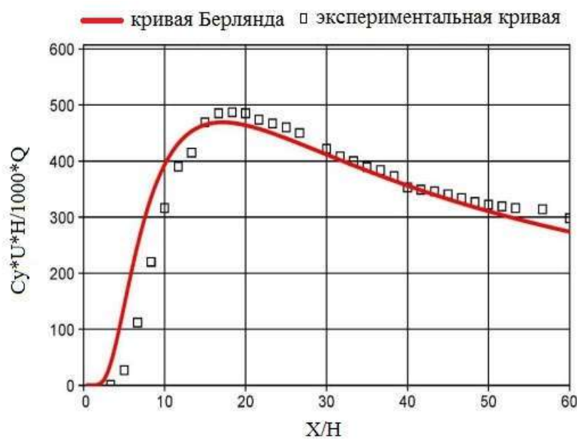
Рисунок 5.2 - Масштабовані, поперечно інтегровані значення концентрації на рівні землі ( z_0=0 ): результати експериментів з аеродинамічної труби (квадрати) з роботи [164]; червона лінія обчислена за формулами спрощеного аналітичного рішення [152]
